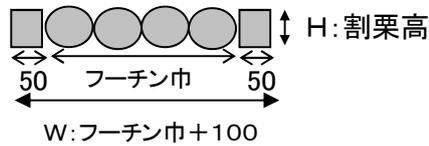
**布基礎根切量** =  $\frac{\text{根切断面積}}{H} \times (\text{布基礎長さ} + \text{フーチングのみ長さ})$
